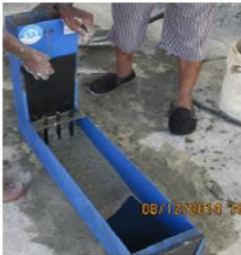
(a) L-box apparatus
